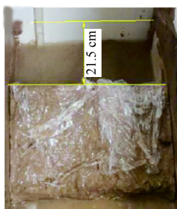
(d) I-2 试验滑动后照片
