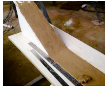
(b) 动摩擦系数测试装置
